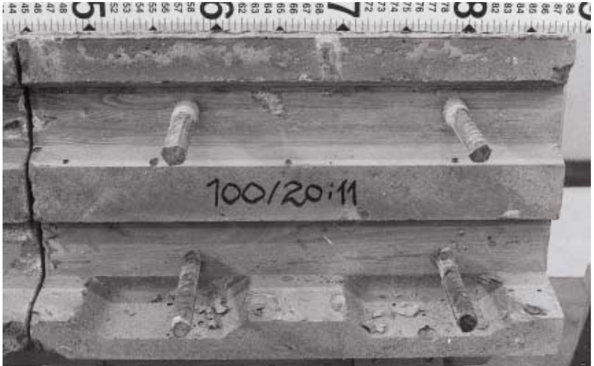
Endestykke af brodæk element med udragende armeringsjern. Der er 20 mm dæklag til armeringsjernene.
