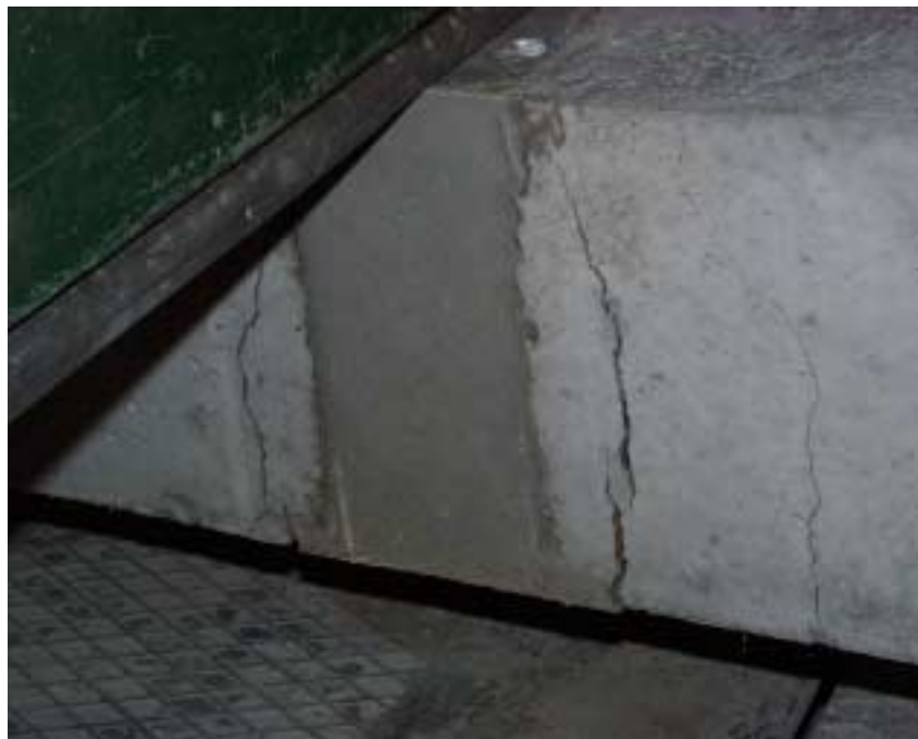
Figur 3 Sammenstøbt bjælke under afprøvning.
